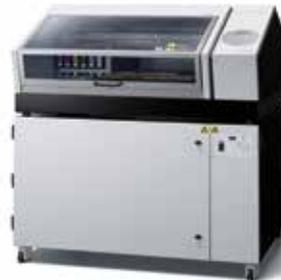
Está disponible un sistema de purificación de aire para la LEF2-200. Este sistema incluye un filtro de carbón activo que elimina de forma efectiva los olores, así como las sustancias volátiles que se generan en la impresión. Esta unidad puede colocarse fácilmente debajo de la LEF2-200.
